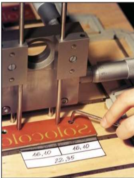
Rys. 3 Przykład umiejscowienia otworów w wykrojniku i matrycy.
